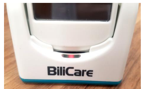
Rotes Licht zeigt das Laden der Batterie an.
