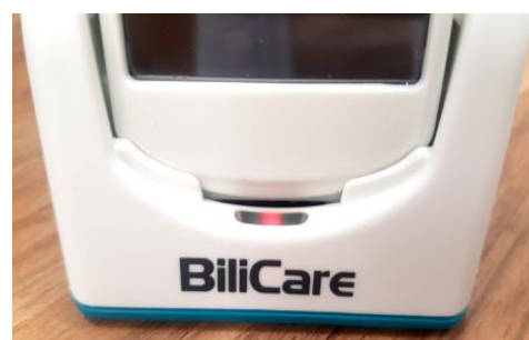
Voyant lumineux rouge indiquant que la batterie est en charge
