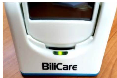
LED verte, indiquant que la batterie est entièrement chargée
