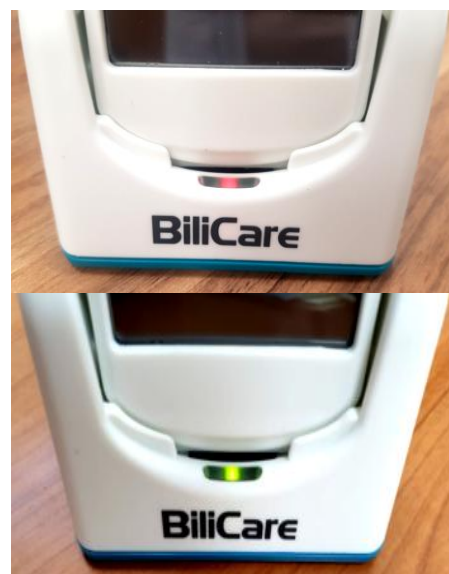
La luz verde indica que la batería está completamente cargada
