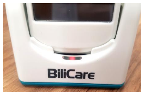
LED vermelho, indicando que a bateria está carregando
