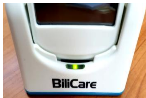
O LED verde indica que a bateria está totalmente carregada
