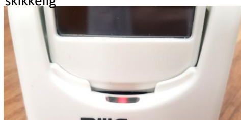
Rød LED, som indikerer at batteriet lades
