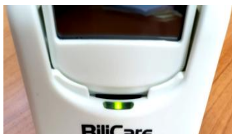
Grønn LED-lampe som indikerer at batteriet er fulladet
